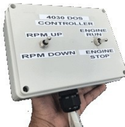
Figura 5.3 - Caja de control remoto (RCB)
