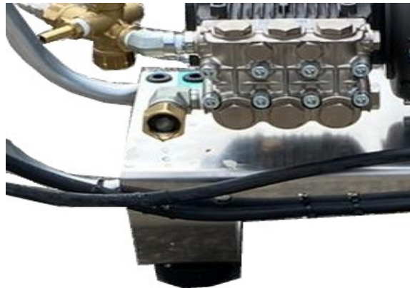
Figura # 4: conecte la manguera de jardín a la entrada de agua
