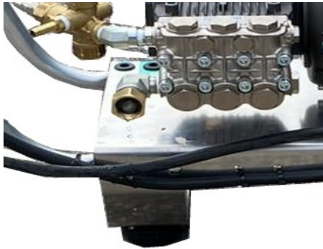
Figura # 1 - Entrada de agua
