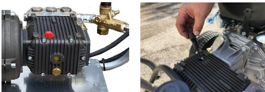
Figura # 2 - Nivel de aceite de la bomba
