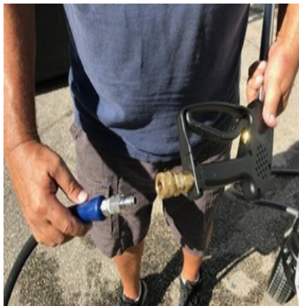
Figura # 7 - Conexión de la pistola a la manguera de alta presión
