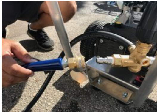
Figura # 6: conecte la manguera de alta presión al regulador de presión de conexión rápida
