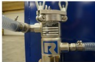
Desatornillar 3 seguros Levantar tapadera
