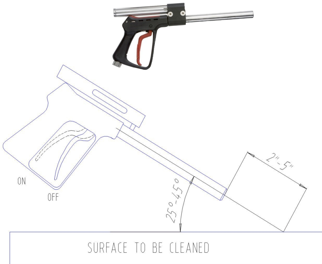
Figura 5.3: Posición de la pistola de empuje cero para obtener los mejores resultados
