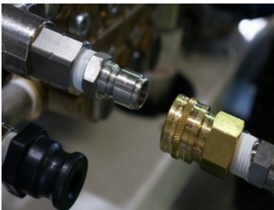
Figura #11 - Alta presión Conexión de manguera
