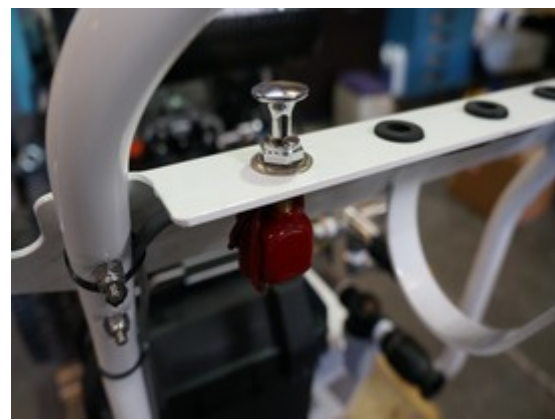
Figura #12 - Interruptor de encendido de la bomba de alimentación
