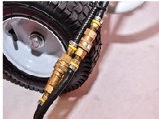
Figura #10 - Línea de combustible Conexión
