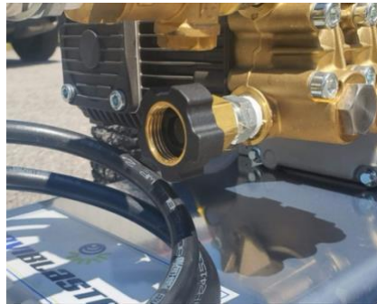
Entrada de agua - Figura # 1
