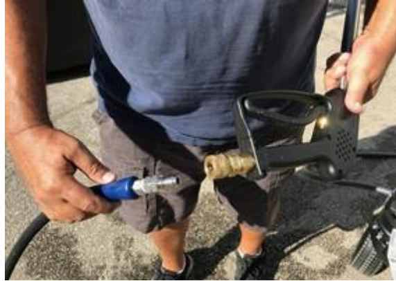
Conexión de la pistola a la manguera de alta presión - Figura # 15
