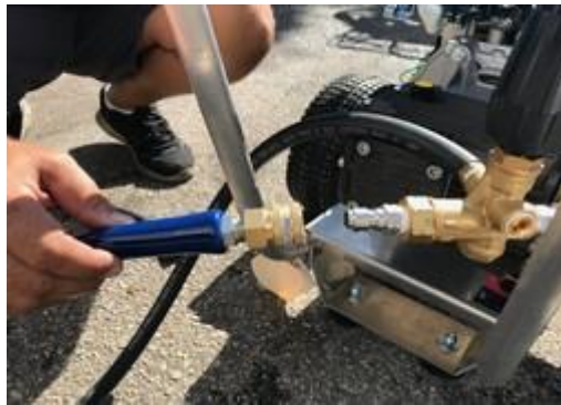
Conecte la manguera HP al regulador de presión bajo conexión rápida - Figura # 11
