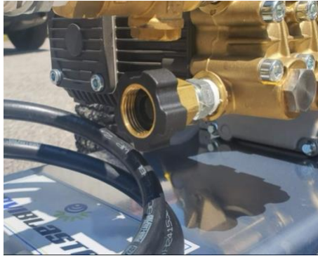
Conecte la manguera de jardín a la entrada de agua - Figura # 9
